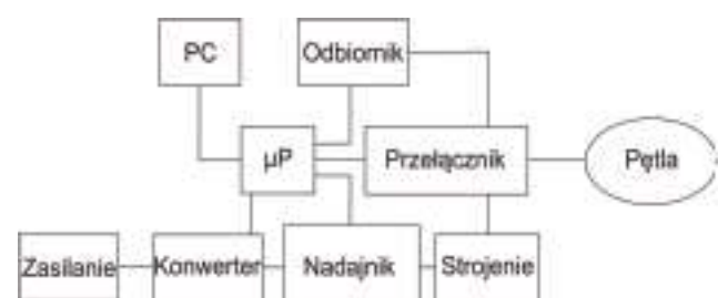
Rys. 3. Konfiguracja zestawu Numis Lite Fig. 3. Numis Lite schematic diagram
