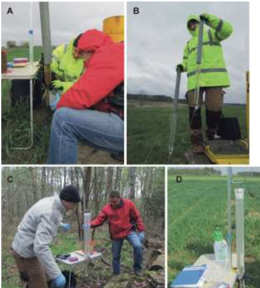
Rys. 6. Fotografie terenowe przedstawiające ostatnią fazę poboru prób wody za pomocą dyskretnego próbnika rękawowego HydraSleeve®. A – piezometr SL-1, B – piezometr H-19 (widać dwa połączone próbki o pojemności 600 mL każdy), C, D – próbki HydraSleeve® z pobraną próbą wody, podwieszane, izolowane od wpływu atmosfery, przygotowane do oznaczeń wskaźnikowych i rozdzielenia wody do analiz chemicznych i izotopowych. Na próbnikach HydraSleeve® (A, B) widoczna osłona z PCV: dodatkowe objaśnienia w tekście.
